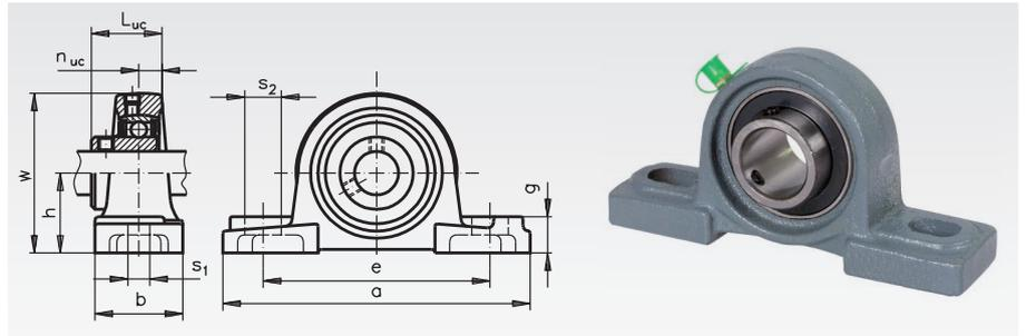
Bestellangaben: z.B.: Art.-Nr. 625 112 00, Kugel-Stehlager UCP 201, Bohrung 12mm
